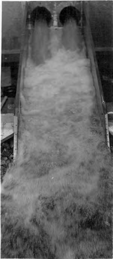
A. NO DIVIDING WALL; 1975 SECOND-FOOT PER VALVE.
